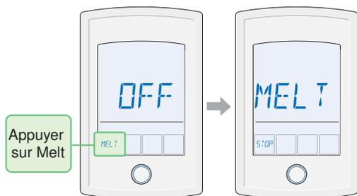
Si un démarrage manuel a été réalisé et qu'un capteur PM-090 ou PM-095 détecte de l'eau, le contrôle passe du mode de fonctionnement de fonte manuel au mode automatique.
